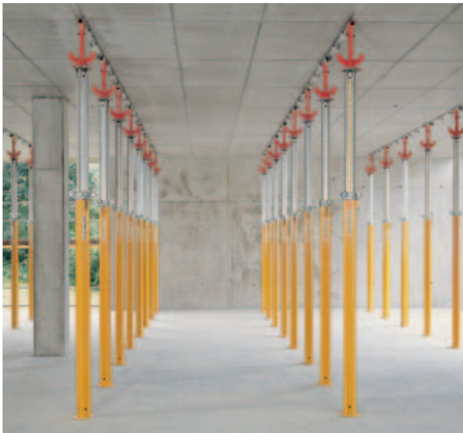
Etais MULTIPROP 350 en tant qu'étalement de séchage après décoffrage du coffrage de plancher SKYDECK. Seulement 0,29 étau/m 2 pour des dalles jusqu'à 40 cm d'épaisseur.
